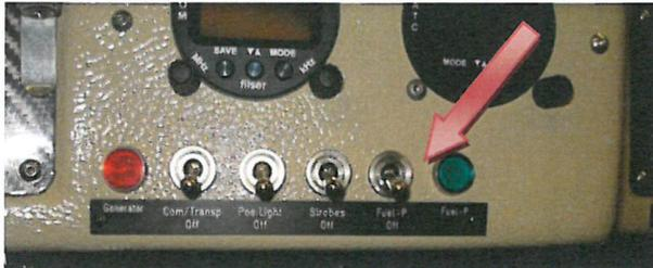
Schalter: 2. Benzinpumpe mit Kontrollleuchte
